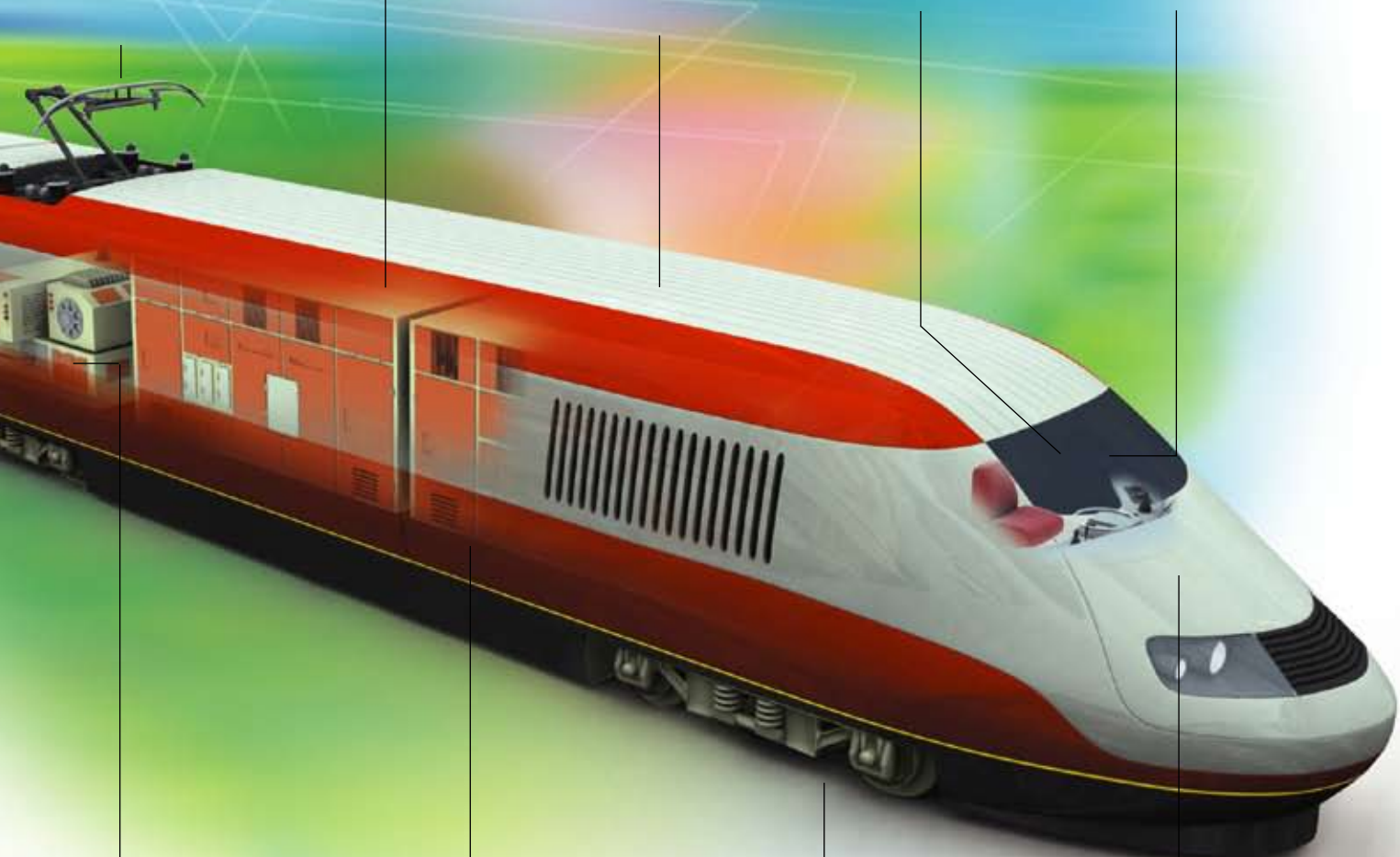
高压连接电缆和接头 将电力从集电弓架 传送到变压器
